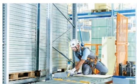
Das PDS Access-Kit von BITO-Lagertechnik ermöglicht im Wartungs-, Reinigungs- und Störfall den sicheren Regalzugang bzw. das gesicherte Arbeiten in den Durchlaufkanälen bzw. Rollenbahnen des Palettendurchlaufregals.
