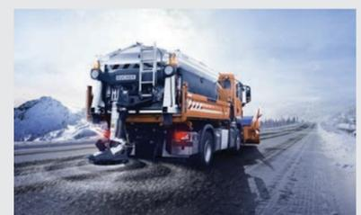
Bei dem Streuautomaten Phoenix Electra ersetzen bürstenlose Elektromotoren den herkömmlichen Hydraulikantrieb.
